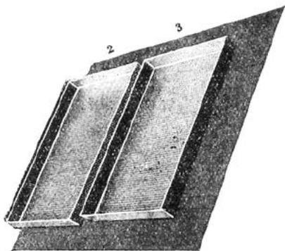
Käfig 2. Lochblech, Stärke 5/10, Maße 275 × 380 mm, Lochgröße 3 mm, Lochabstand 3 mm, Die Kanten, mit einer Breite von 20 mm, wurden nach dem Einschneiden der Ecken abgewinkelt. Sie sind nicht verschweißt.
