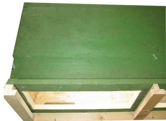
Abbildung 2: Untermontierte Falzleisten. Ansicht von unten, linke Beutenseite.
